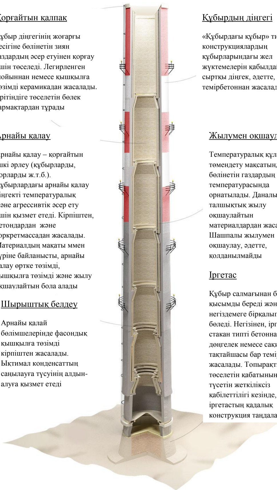
1-сурет – Темірбетон түтін мұржасының схемасы
