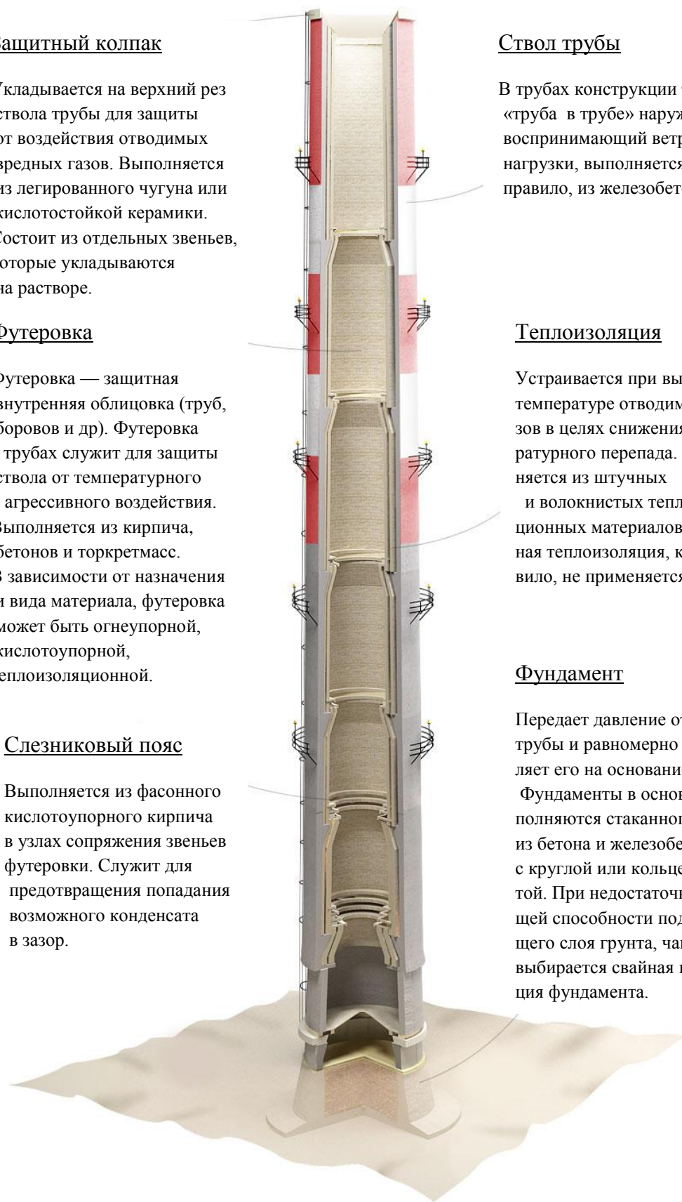
Рисунок 1 – Пример сборной железобетонной дымовой трубы
